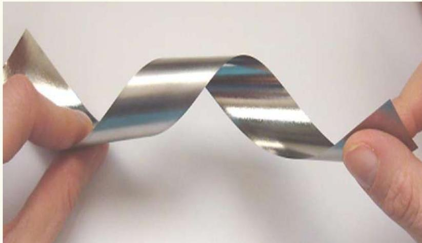
**アモルファス合金**は、強度は鉄の**20倍**、錆びる可能性はステンレスの**100万分の1**という性質を持った大変耐久性の高い強靱な素材です。アモマットには日本の大手メーカーの製造する信頼のおけるアモルファス合金を使用しています。
